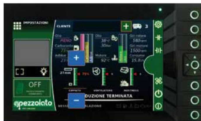
ELEKTRONICZNY STEROWNIK Z 7-CALOWYM PANELEM DOTYKOWYM
