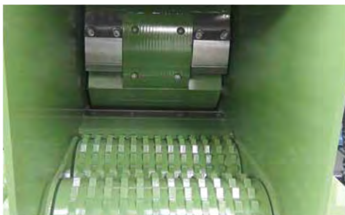
System rolek podających z bębniem 3-nożowym
