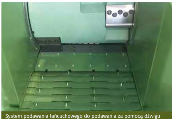
Rębak rozdrabniający kłody przystosowany do podawania dźwigiem
