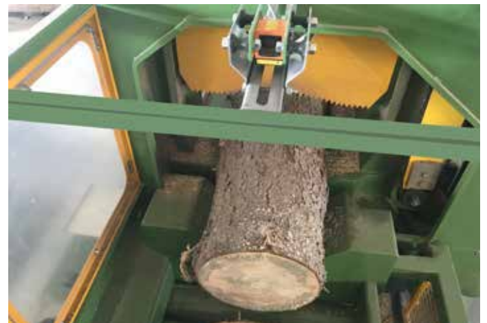
Fotocellula per misurazione automatica lunghezza ceppo
