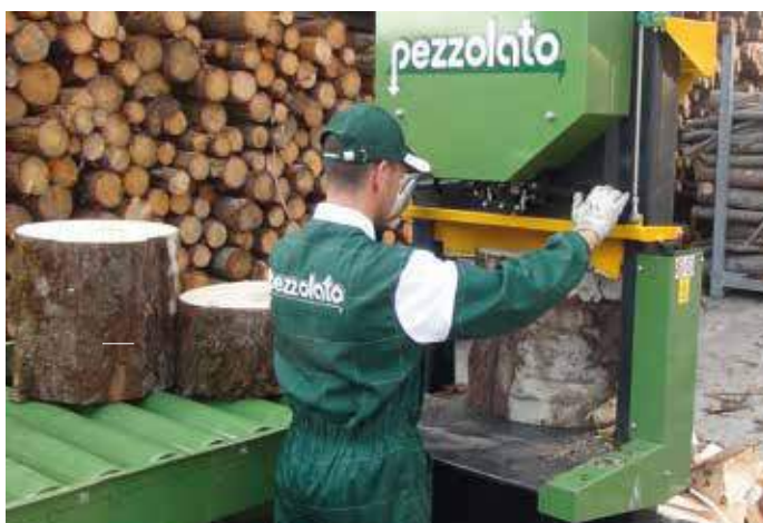
Doppio comando idraulico manuale per spaccalegna
