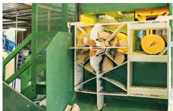
Griglia di spacco regolabile
