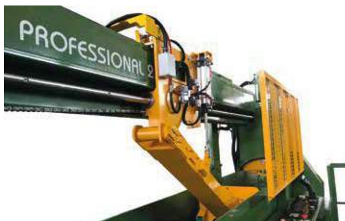
Spintore sollevabile meccanico pneumatico
