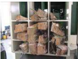
Griglia di spacco GENIUS WEDGE progettata per ottenere legna da ardere calibrata in un unico passaggio ottimizzando i diametri e minimizzando lo scarto
