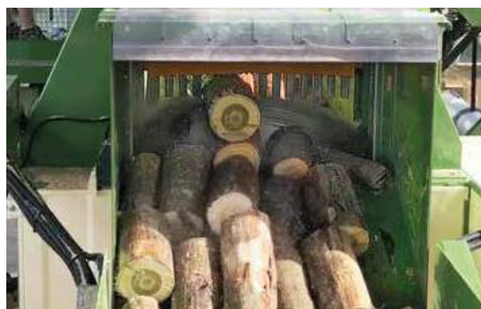
Bloccaggio con martinetti meccanici efficace con qualsiasi materiale
