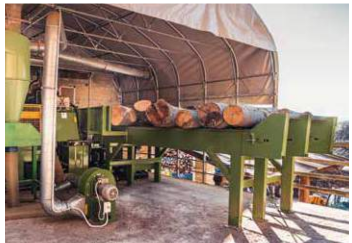
Caricatronchi a 3 catene, lunghezza 4 metri
