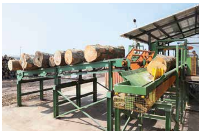
Culla portatronchi con spintore posteriore
