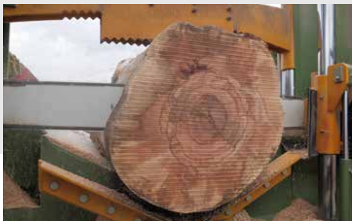
Catena troncatrice a scorrimento orizzontale
