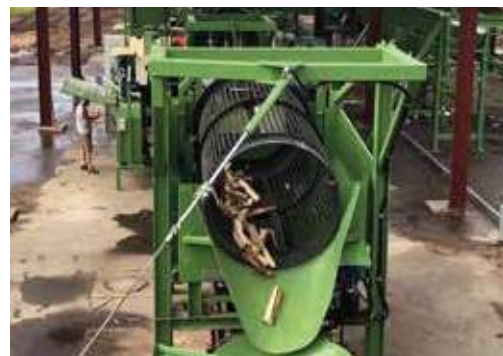
Vaglio a tamburo con diametro da 1800 mm
