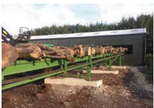
Caricatronchi con lunghezza 25 metri
