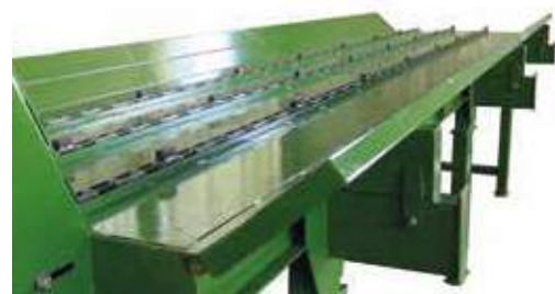
Caricatronchi 3 catene per legna da 1 metro e sponde meccaniche per contenimento materiale
