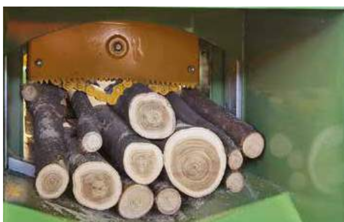
Bloccaggio a catena efficace con qualsiasi materiale
