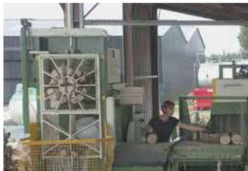
Stazione di spacco 32 Ton, griglia 2+4+6+16 vie
