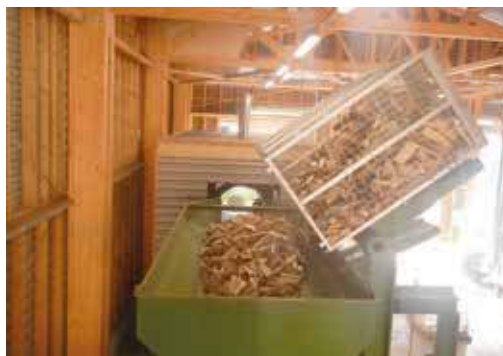
Vaglio a tamburo con tramoggia di alimentazione
