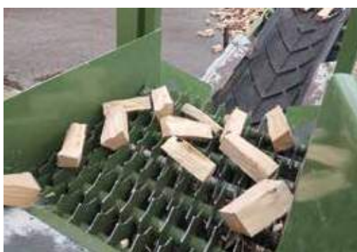
Rulli pulitori abbinati ad impianto Pezzolato TB 900
