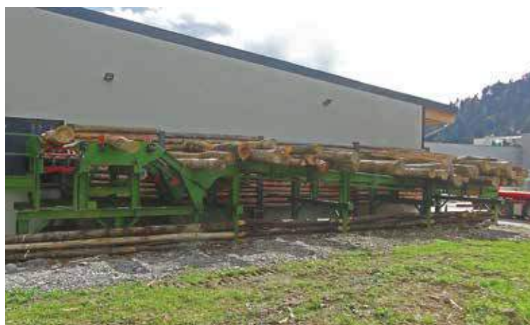
Caricatronchi con singolarizzatore
