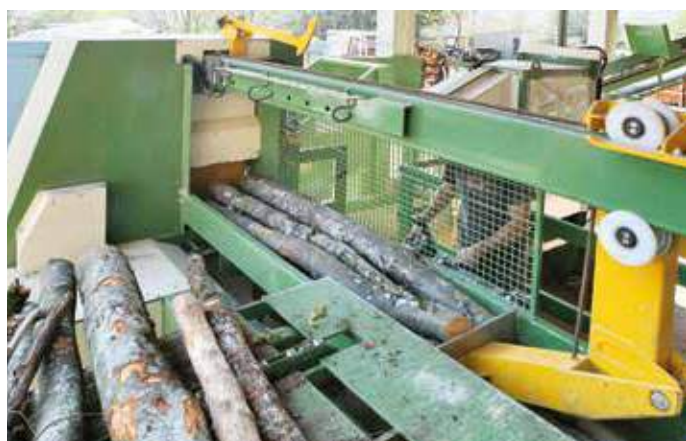
Canale di alimentazione e spintore
