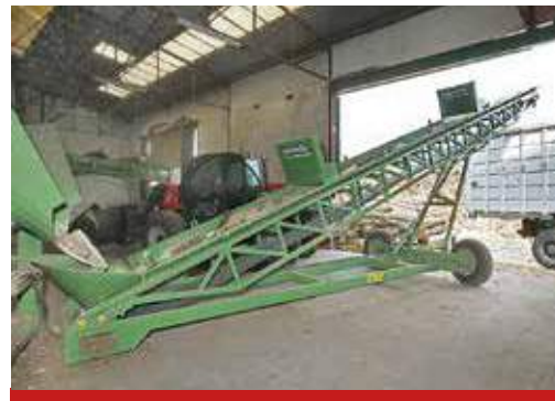
Nastro con motorizzazione idraulica delle ruote
