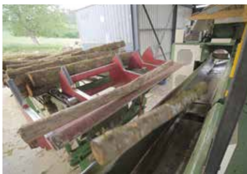
Sistema di caricamento a mezzelune
