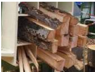
Griglia di spacco GENIUS WEDGE progettata per ottenere legna da ardere calibrata in un unico passaggio ottimizzando i diametri e minimizzando lo scarto
