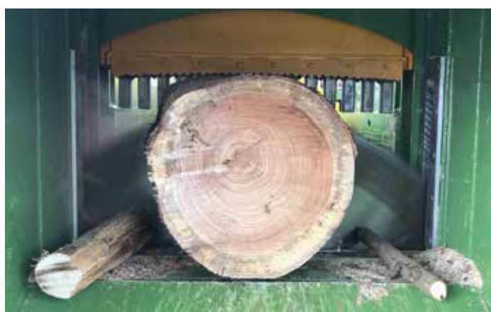
Alimentazione con tronchi di grosso diametro (TLA)
