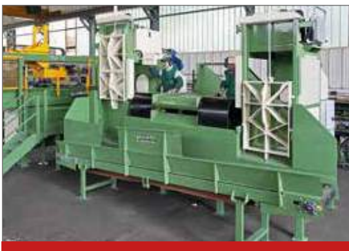
Nastro piano di evacuazione per due spaccalegna
