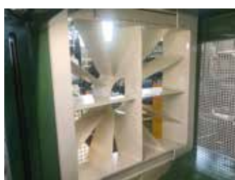
Settore di spacco amovibile per manutenzione con 10 oppure 12 oppure 16 oppure 24 vie
