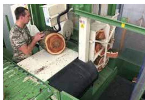
Stazione di spacco 20 Ton, griglia 2+4+6 vie
