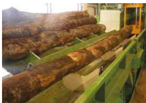
Sistema di caricamento con spintori
