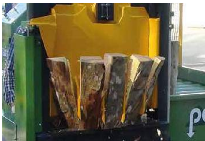
Cuneo con 4 coltelli orbitali per ottenere 5 ceppi a ciclo
