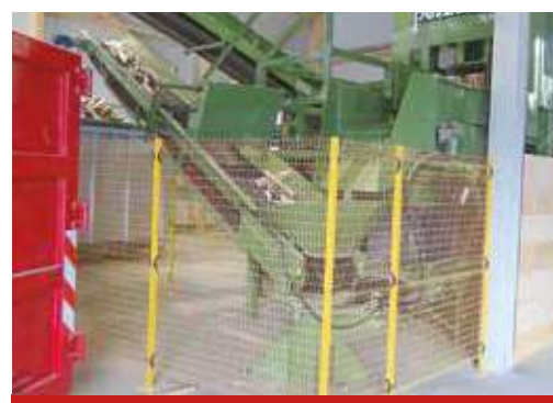
Nastro con ralla per fissaggio a pavimento
