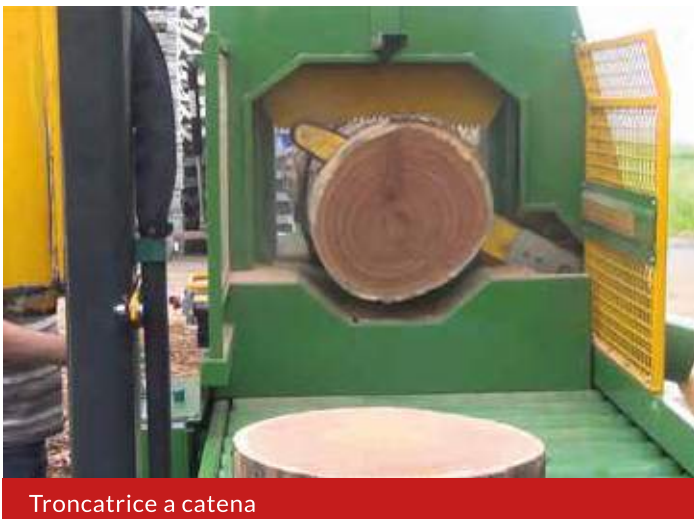
Tavolo a rulli motorizzati per trasferimento ceppi tagliati
