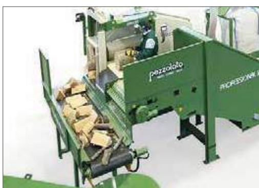
Nastro piano di evacuazione per uno spaccalegna
