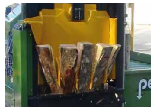
VS 60 - Coin de fente courbée avec 4 couteaux orbitaux
