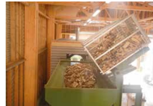
Crible à tambour avec trémie d'alimentation
