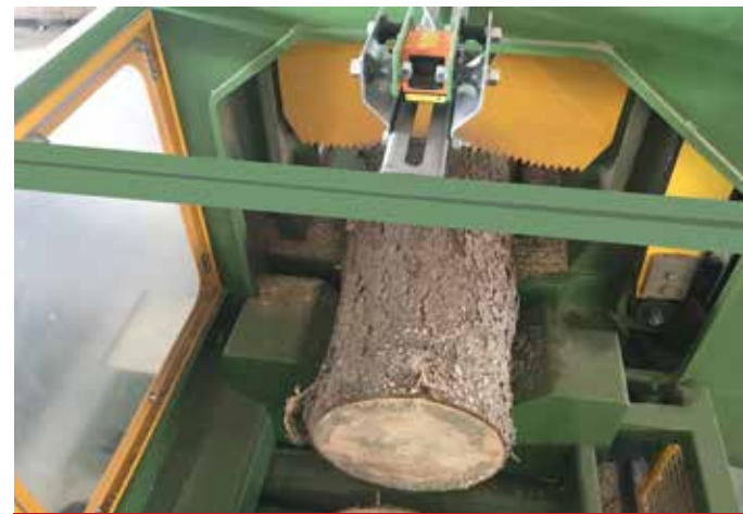
Photocellule pour la mesure automatique de la longueur des grumes
