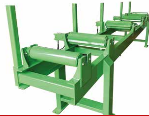
Convoyeur à galets 4900 mm pour chargement/avancement troncs
