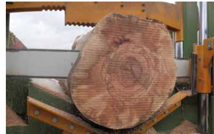
Chaîne de tronçonnage à coulissement horizontale
