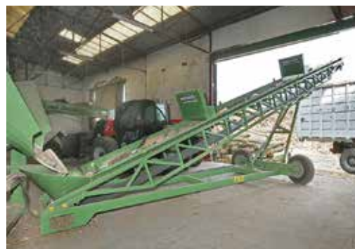
Convoyeur avec motorisation hydraulique des roues orientables
