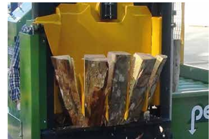
Coin avec 4 couteaux orbitaux pour obtenir 5 blocs par cycle
