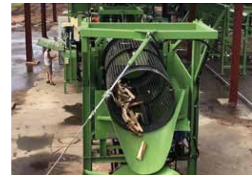
Crible à tambour avec diamètre 1800 mm
