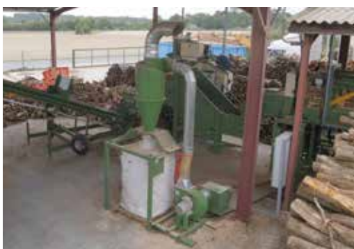
Aspirateur avec système de collecte dans des sacs
