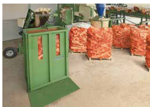
Palettiseur actionné par l'hydraulique de la machine
