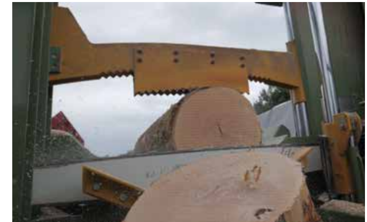
Bloquage tronc hydraulique à guillotine
