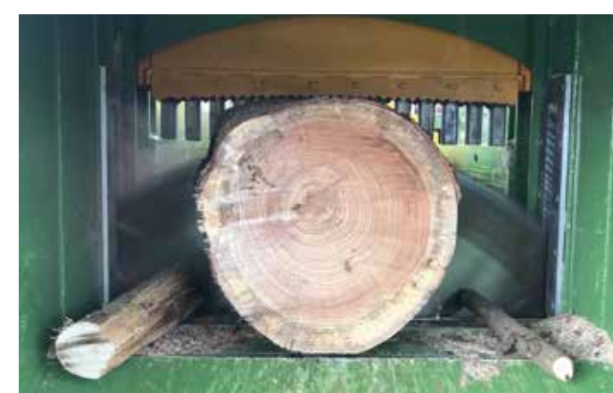
Alimentation avec des troncs de grand diamètre (TLA)
