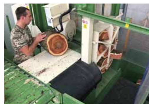
Station de fente 20 Ton, grille de fente 2+4+6 voies
