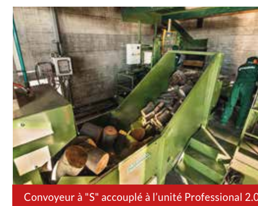
Convoyeur à "S" accouplé à l'unité TLC 1200
