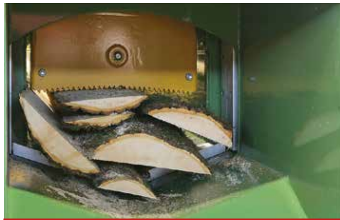
Alimentation avec des dos de scierie
