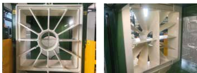
Grille de fente GENIUS WEDGE conçue pour obtenir du bois de chauffage calibré en un seul passage en optimisant
