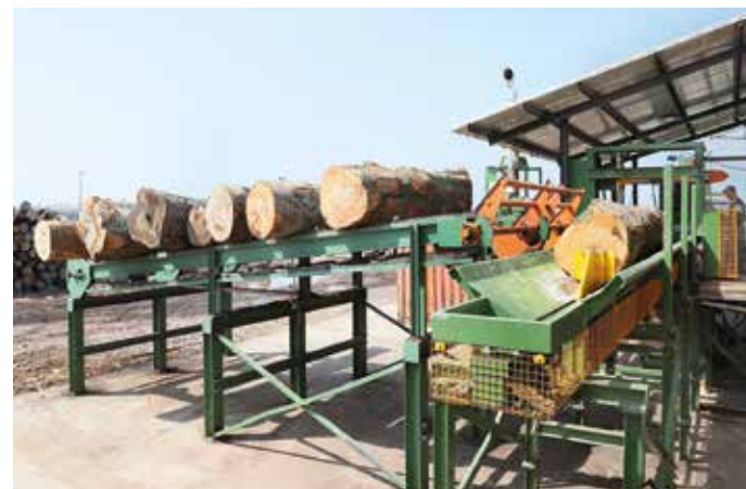
Berceau porte troncs avec poussoir arrière
