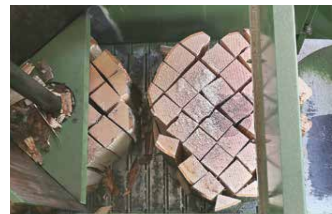
Coin de fente pour système de fendage vertical automatique
