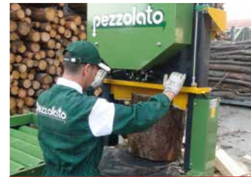
VS 60 - Doble control hidráulico manual
