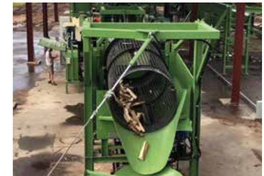
Tamiz de tambor con un diámetro de 1800 mm
