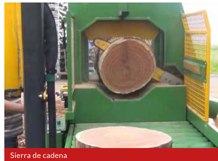
Mesa de rodillos motorizados para trasladar troncos cortados
