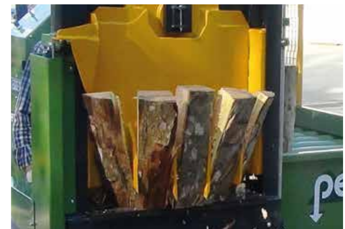
Cuña con 4 cuchillas orbitales para obtener 5 leños por ciclo
