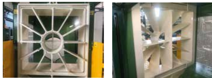
Sector de rajado extraíble para mantenimiento con 10 o 12 o 16 o 24 vías
