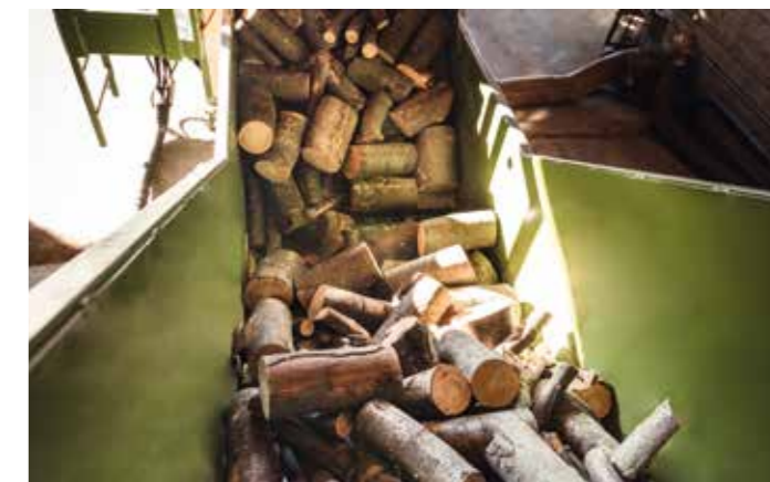
Cinta transportadora con acumulador de madera cortada
