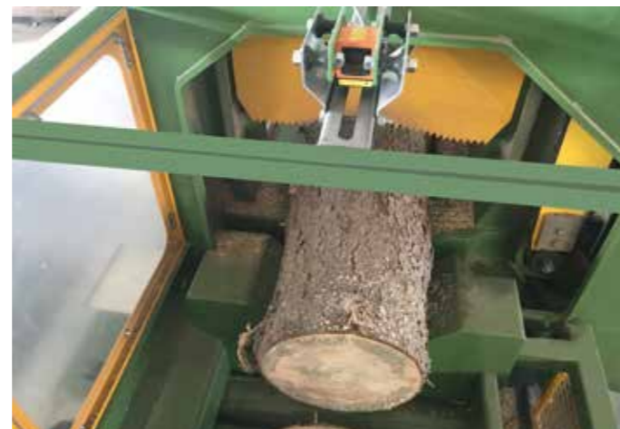
Fotocélula para medición automática longitud troncos
