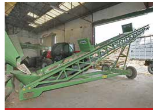
Cinta transportadora con motorización hidráulica de las ruedas orientables
