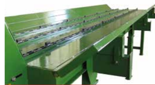
Cargador 3 cadenas para madera de 1 m y barreras laterales mecánicas para retención de material
