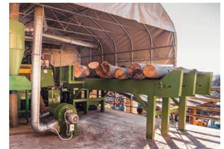
Cargador de troncos con 3 cadenas, longitud de 4 metros
