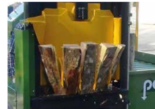
VS 60 - cuña curva con cuatro cuchillas orbitales
