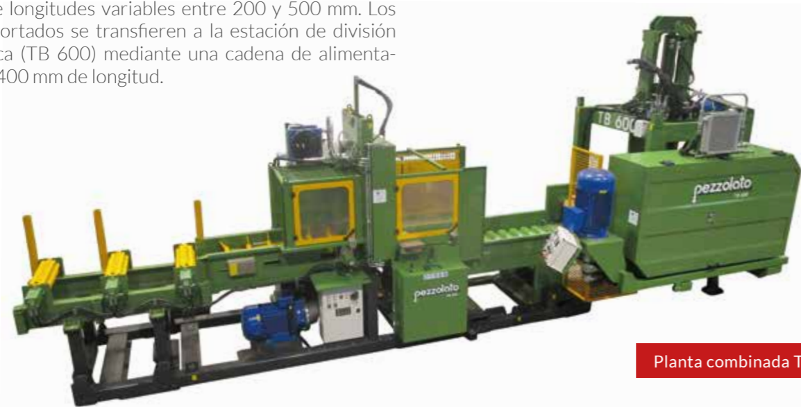
Transportador de rodillos de 4900 mm para la carga y el transporte de troncos
