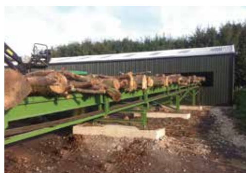
Cargador con una longitud de 25 metros
