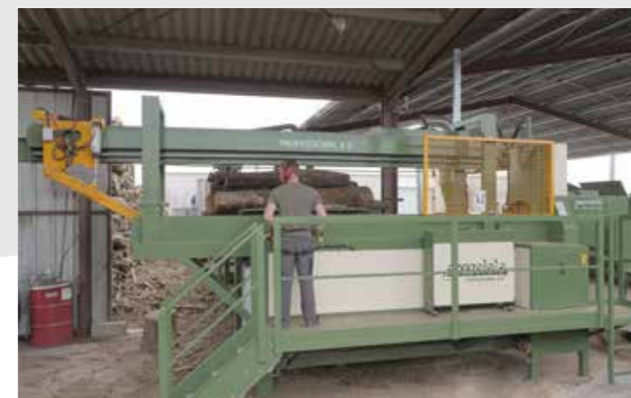
Plataforma para púlpito de mando con escalera de paso
