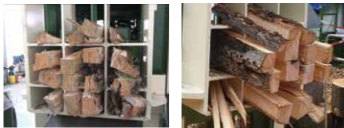
Parrilla de rajado GENIUS WEDGE diseñada para obtener leña calibrada en un único pasaje, optimizando diámetros y minimizando desecho
