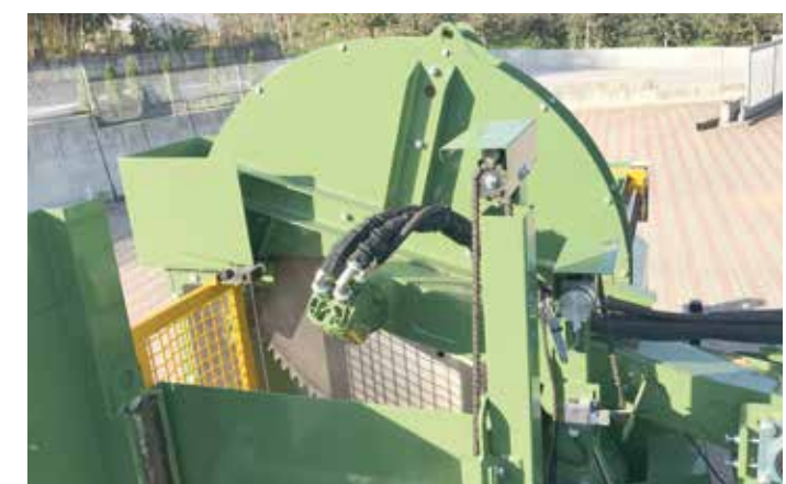
Kreissäge mit hydr. Antrieb (TLF)
