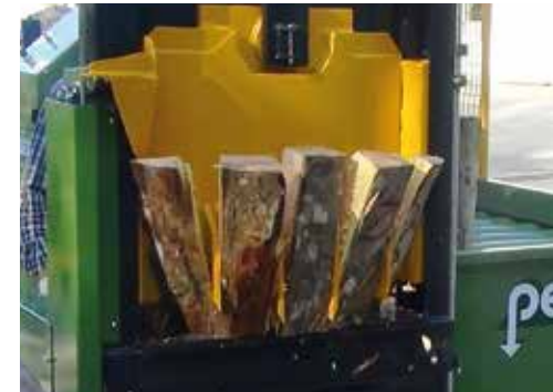
VS60-Segmentbogenkeil mit 4 Orbitalmessern
