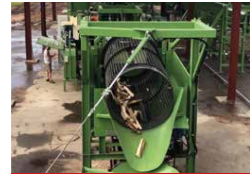
Trommelreiniger mit 1800 mm Trommeldurchmesser
