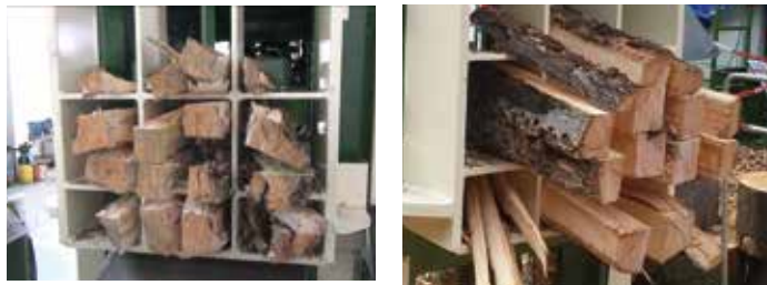
GENIUS Spaltkeil wurde gebaut, um mit einem Spalthub gleichmäßige rechteckige Scheite zu erhalten mit wenig Spreiselanteil.
