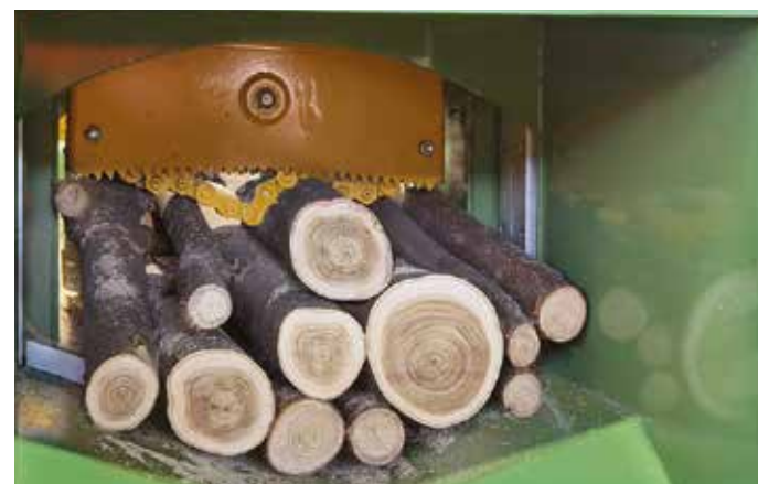
Kettenklemmsystem für Bündelverarbeitung
