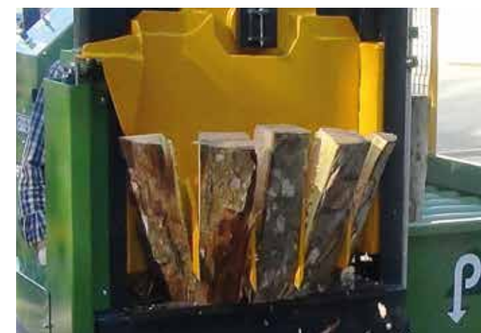
Spaltkeil mit 4 Orbitalmessern mit 5 Scheiten
