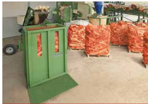
Palettenpacker mit Hydrauliantrieb von der Maschine
