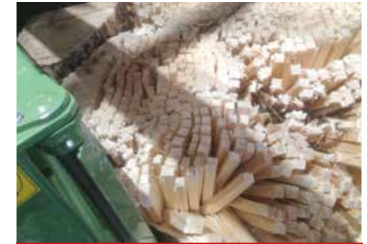
Anzündholzproduktion mit TB900 Vertikalspalter
