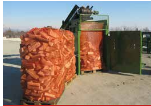
Palettenpacker mit Hydraulikaggregat
