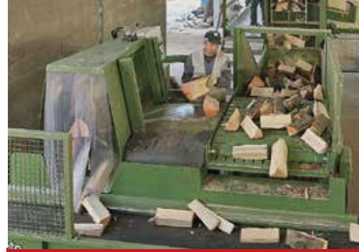
11t Spaltstation mit 2+4-fach Keil
