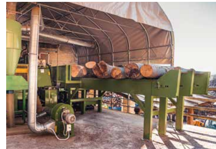
Beschicker für Stammstücke mit 3 Einzugsketten, Länge 4 Meter
