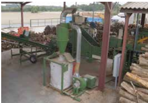
Absaugstation mit BigBag
