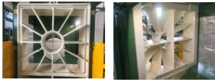
Austauschbare Rahmen für Wartungszwecke oder Spaltkeilwechsel, 10, 12, 16, 18 oder 24-fach
