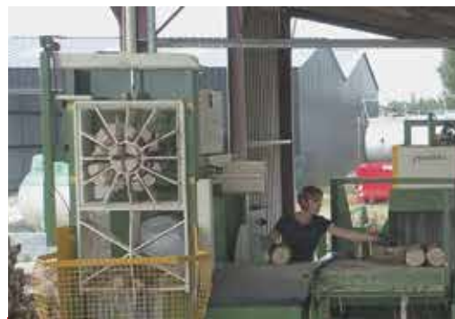
32t Spaltstation mit 2+4-6-+16-fach Keil
