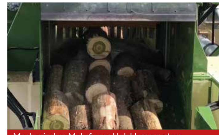
Mechanisches Mehrfinger Holzklammersystem, besonders effizient beim Bündelschneiden
