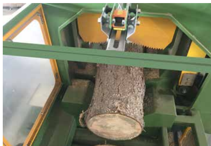
Fotozelle für die automatische Log-Längenmessung
