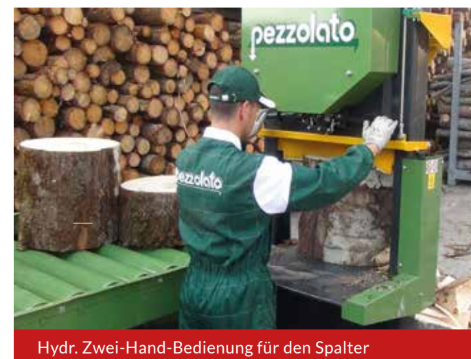
Spaltkeil mit 4 Orbitalmessern mit 5 Scheiten
