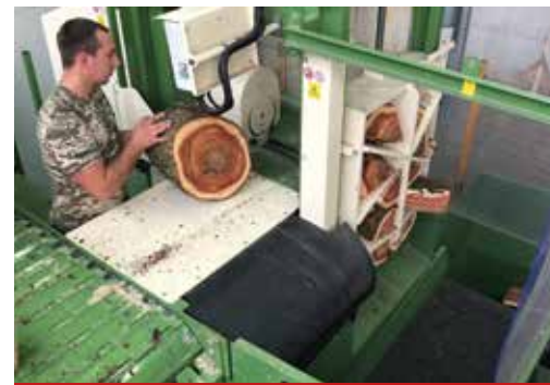
20t Spaltstation mit 2+4-6-fach Keil
