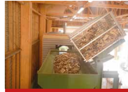
Trommelreiniger mit Ladetrichter
