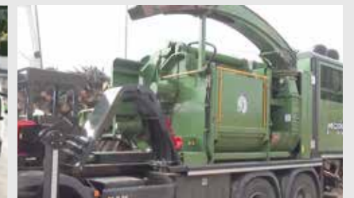
Accionamiento grúa con motor de la máquina
