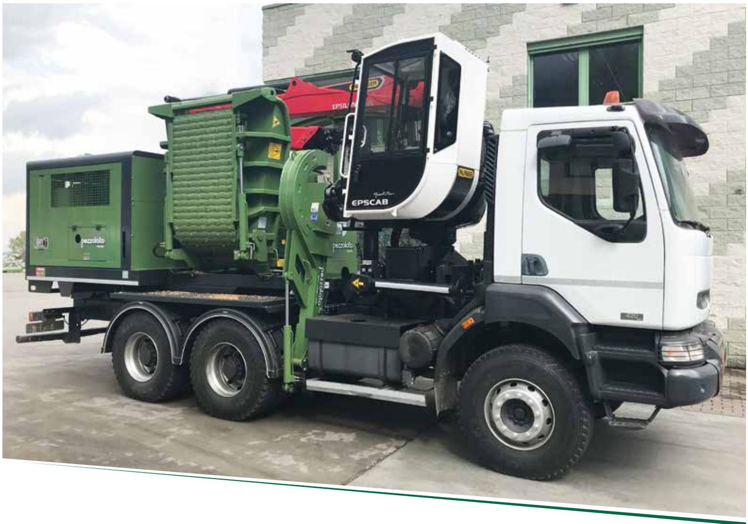
Il ventilatore di grosso diametro (1250 mm), montato direttamente sull'albero del tamburo, è in grado di lavorare ad un basso numero di giri (meno di 600) per ridurre l'effetto polvere ed aumentare la qualità del cippato.
