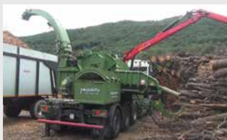
Macchina con tramoggia in posizione standard
