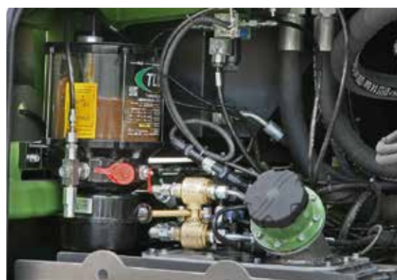
Sistema di ingrassaggio automatico
