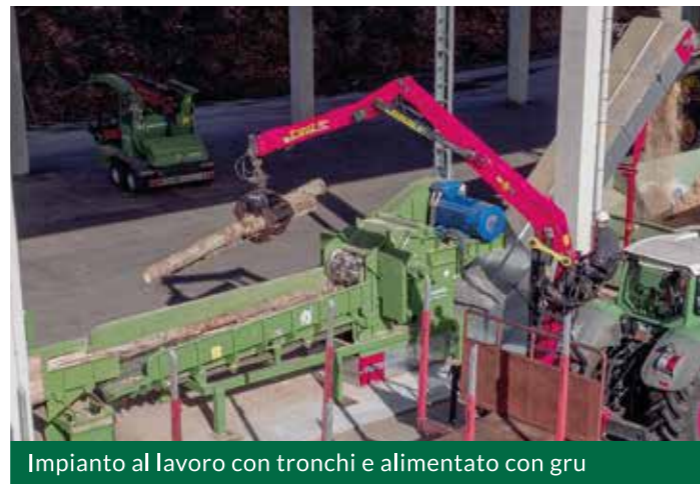
Sistema di introduzione a catena per alimentazione con gru
