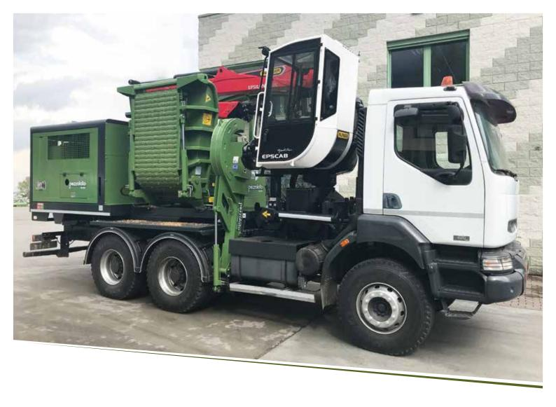
La soufflerie possède un diamètre trés important (1250 mm). Elle est montée directement sur l'arbre du tambour. Ceci dans le but de tourner à basse vitesse (600 tours environ) dans le but de réduire la quantité de poussière et d'augmenter la qualité des plaquettes.
