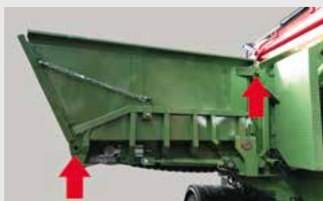
Crochets rapides sur les ridelles/côtés du bac
