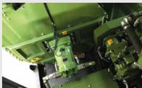
Motore idraulico per ventilatore
