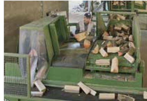
11t Spaltstation mit 2+4-fach Keil
