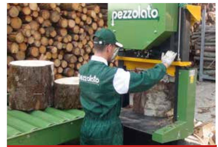
Hydr. Zwei-Hand-Bedienung für den Spalter
