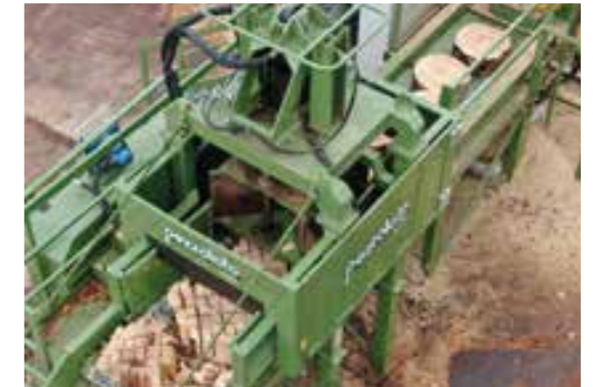
Automatischer Vertikalspalter TB 900
