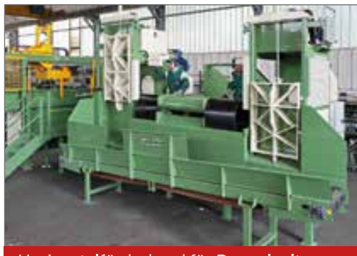
Horizontalförderband für Doppelspalter
