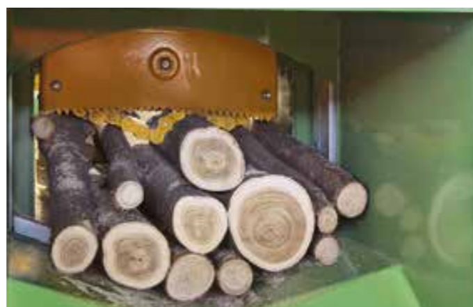
Kettenklemmsystem für Bündelverarbeitung
