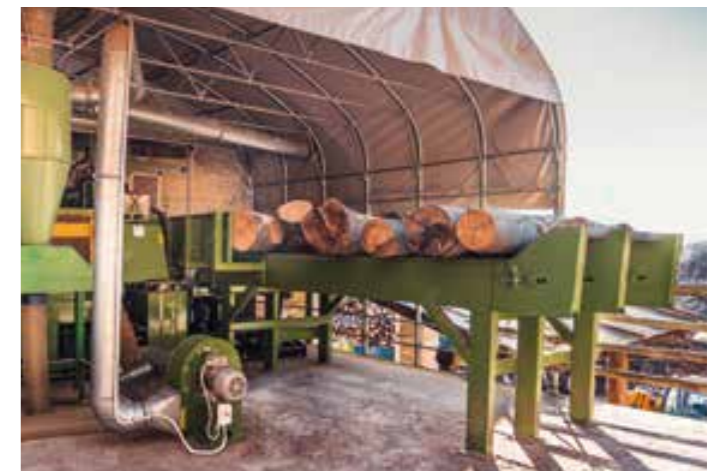
Beschicker für Stammstücke mit 3 Einzugsketten, Länge 4 Meter
