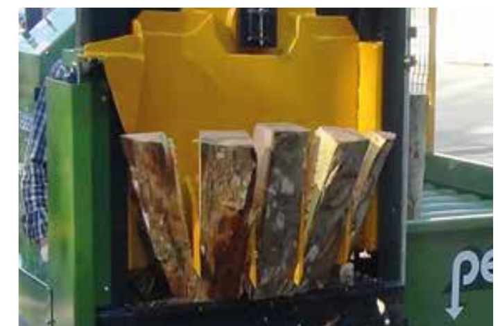
Spaltkeil mit 4 Orbitalmessern mit 5 Scheiten
