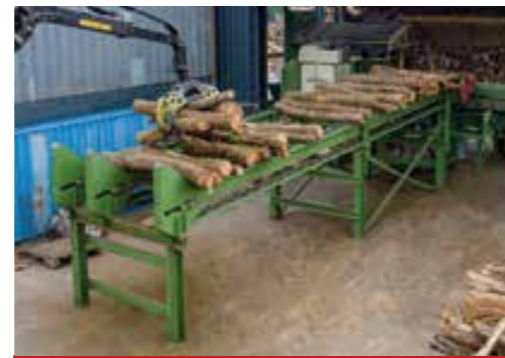
Ladetisch mit offenen Endanschlägen
