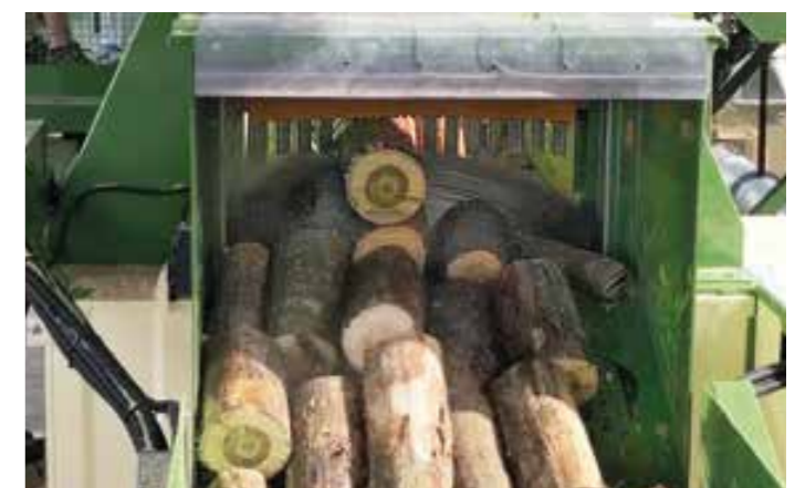
Mechanisches Mehrfinger Holzklammersystem, besonders effizient beim Bündelschneiden
