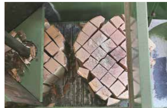
Spaltkeil des Vertikalspalters
