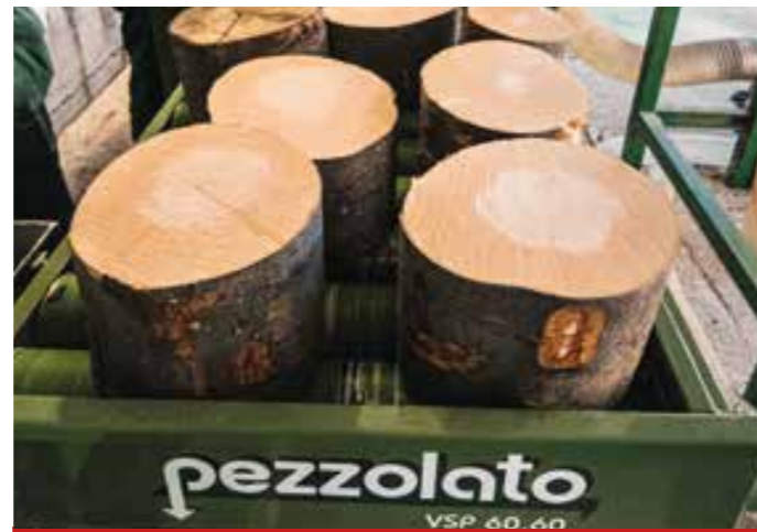
Rollengang mit hydr. angetriebenen Rollen
