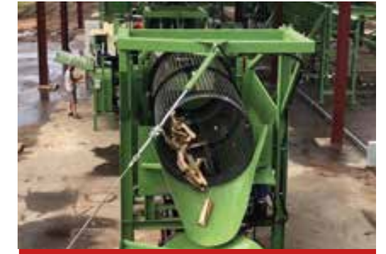
Trommelreiniger mit 1800mm Trommeldurchmesser
