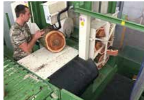
20t Spaltstation mit 2+4-6-fach Keil
