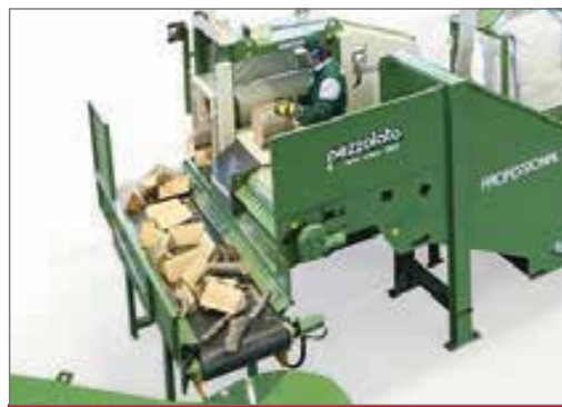
Horizontalförderband für Einzelspalter
