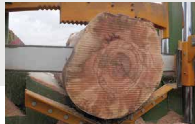
Vertical geführte Kettensäge
