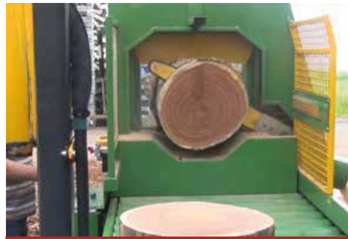
Kappstation mit Kettensäge
