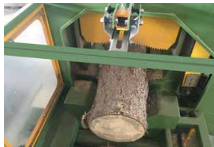
Fotozelle für die automatische Log-Längenmessung
