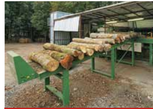
Ladetisch mit geschlossenem Endanschlag
