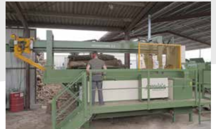
Bedienerplattform mit Aufstiegstreppe
