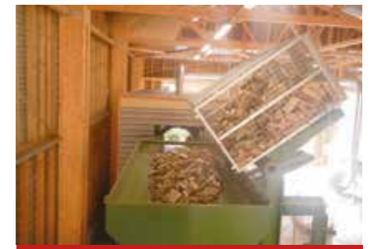
Trommelreiniger mit Ladetrichter
