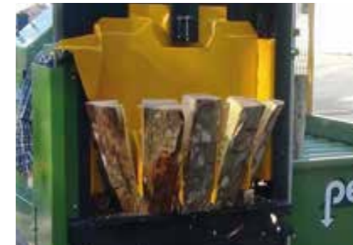
VS60-Segmentbogenkeil mit 4 Orbitalmessern
