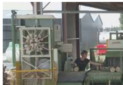
32t Spaltstation mit 2+4-6-+16-fach Keil
