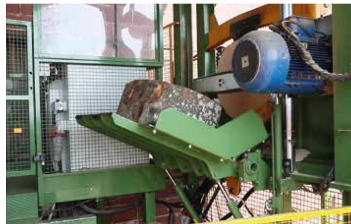
Convoyeur basculant pour la sortie des grumes coupées
