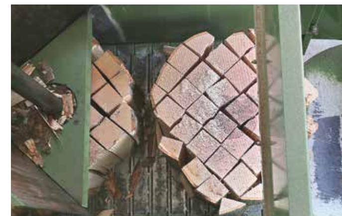
Fendeur pour équipement de fente verticale automatique
