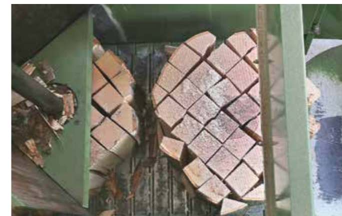
Cuneo di spacco per sistema di spacco verticale automatico
