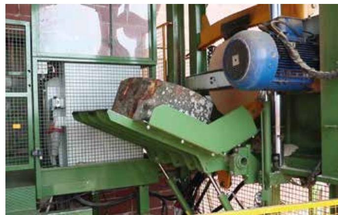
Superficie inclinada para la descarga de troncos cortados
