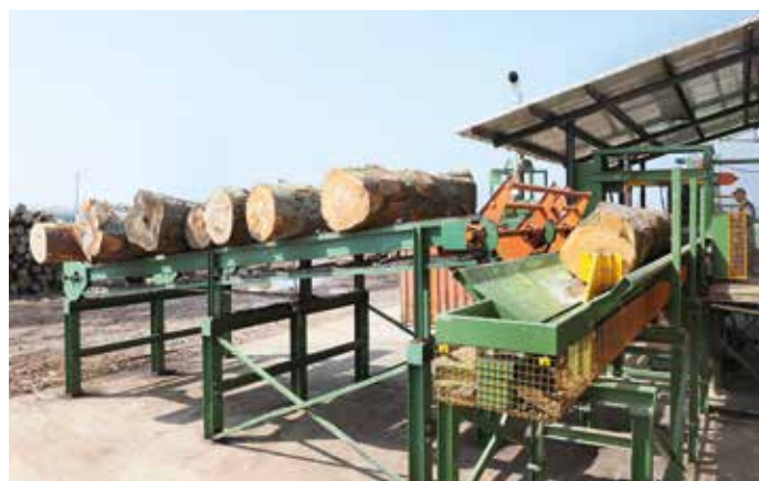
Cuña de alimentación con empujador trasero
