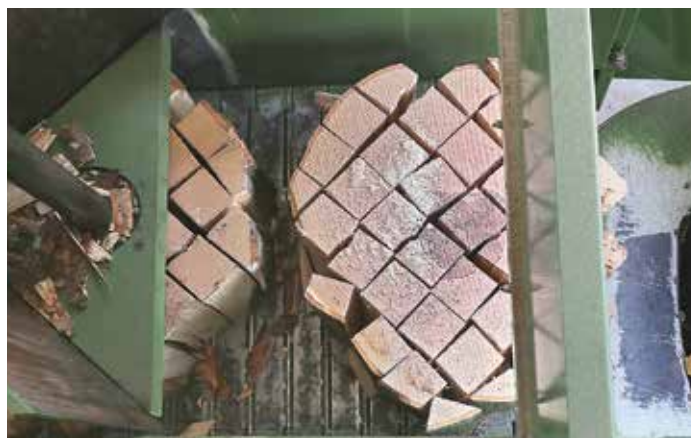
Cuña para sistema automático de rajado vertical
