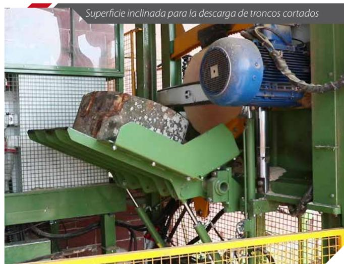
*Superficie inclinada para la descarga de troncos cortados*
