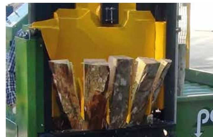
Coin avec 4 couteaux orbitaux pour obtenir 5 blocs par cycle
