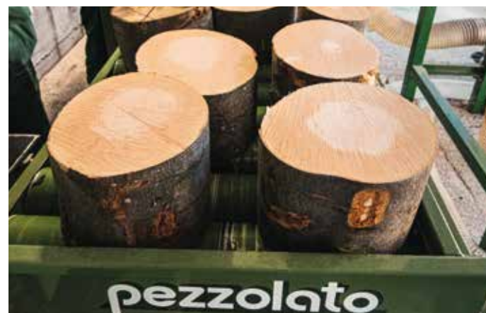
Mesa de rodillos motorizados para trasladar los troncos cortados
