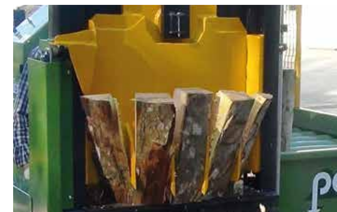
Cuña con 4 cuchillas orbitales para obtener 5 leños cortados por ciclo
