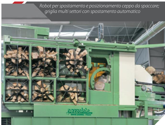
*Robot per spostamento e posizionamento ceppo da spaccare; griglia multi settori con spostamento automatico*
