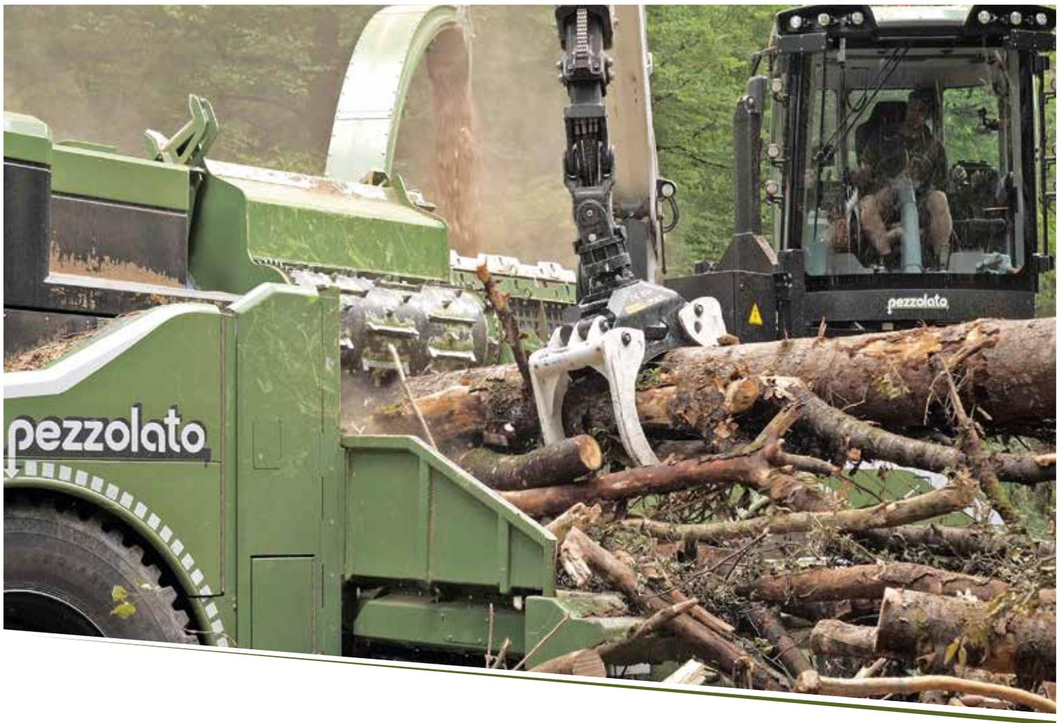
Das Holz wird durch die Schneidwirkung der Hackmesser in gleichförmige Chips verarbeitet und diese können unmittelbar nach dem Schnitt das Kalibriersieb passieren.
