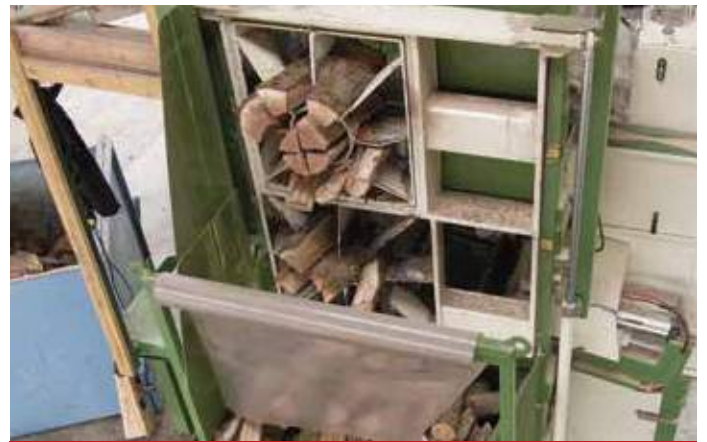
TLC - verstellbarer Spaltkeil
