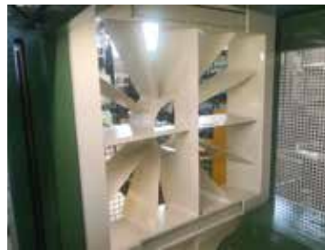
Einfach austauschbares Spaltfenster für Wartungsarbeiten oder Wechsel mit 10 oder 12 oder 16 oder 18 oder 24-fach Spaltkeil
