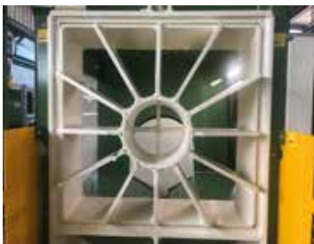
Einfach austauschbares Spaltfenster für Wartungsarbeiten oder Wechsel mit 10 oder 12 oder 16 oder 18 oder 24-fach Spaltkeil
