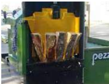
VS 60 – gebogener Spaltkeil mit 4 Orbitalmessern VS 60 – hydraulische Zwei-Hand-Bedienung
