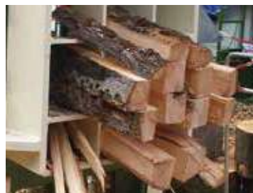
GENIUS-Spaltkeil entworfen um auch aus unterschiedlichen Durchmessern gleichmäßige rechteckige Scheite bei sehr geringem Spreiselanteil zu erhalten
