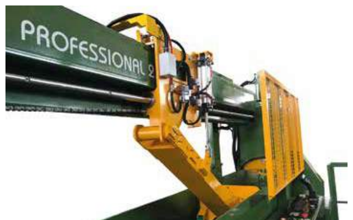
Hochstellbarer Vorschubarm, mechanisch oder pneumatisch
