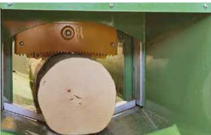
Beschickung mit Rundholz
