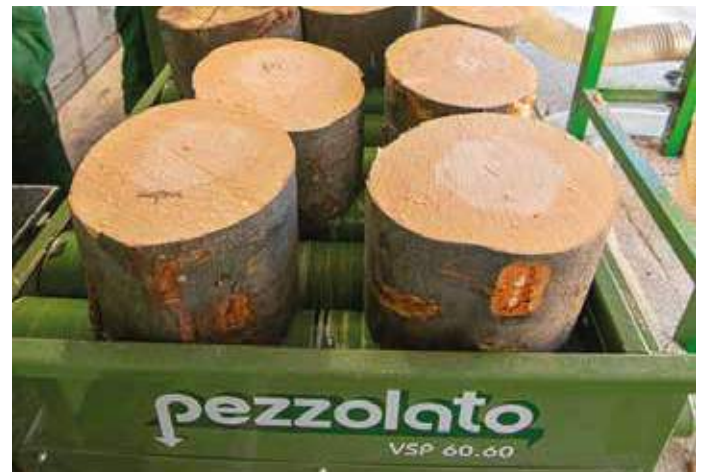
Angetriebener Rollengang für Holzübergabe
