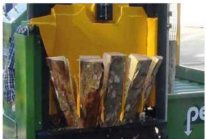
Spaltmesser mit 4 Orbitalklingen erzeugen 5 Scheite je Hub
