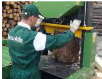
VS 60 – gebogener Spaltkeil mit 4 Orbitalmessern VS 60 – hydraulische Zwei-Hand-Bedienung
