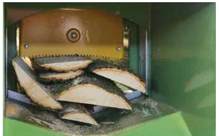
Beschickung mit Sägewerks-Schwarten
