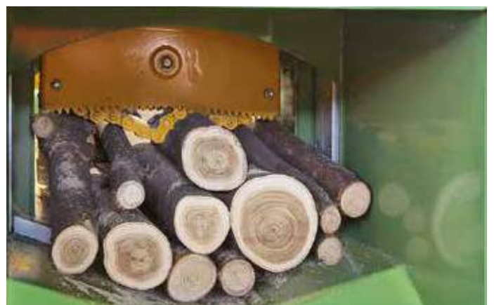
Stammklemmung mit Klemmkette für Rundholzbündel
