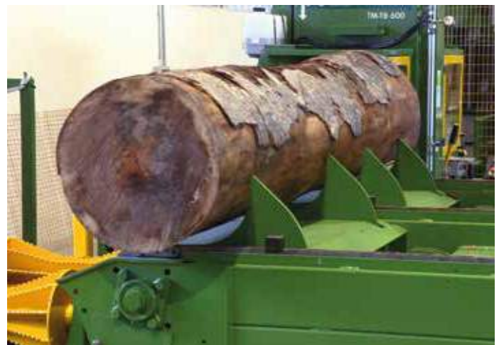
Stammlader mit 3-fach Förderkette für 4 m Rundholzlänge
