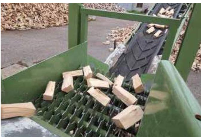
Siebscheibenreiniger für Rindenreste und Spreisel
