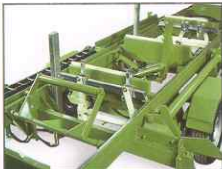
Timber Queen HD5 mobile avec l'équipement hydraulique standard
