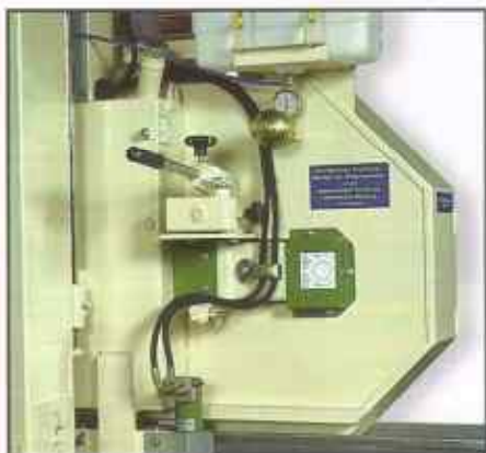
Timber Queen HD7/8 système de tension de lame Timber Queen HD7/8 hydr. blade tension device
