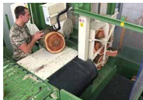
Stazione di spacco 20 Ton, griglia 2+4+6 vie
