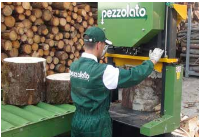
Doppio comando idraulico manuale per spaccalegna
