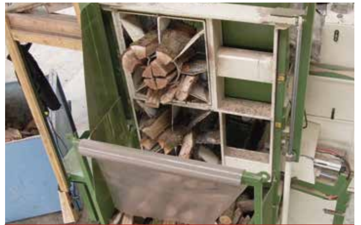
TLC - Griglia di spacco regolabile
