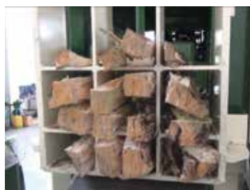
Griglia di spacco GENIUS WEDGE progettata per ottenere legna da ardere calibrata in un unico passaggio ottimizzando i diametri e minimizzando lo scarto
