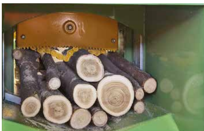
Bloccaggio a catena efficace con qualsiasi materiale
