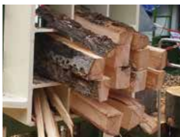
Griglia di spacco GENIUS WEDGE progettata per ottenere legna da ardere calibrata in un unico passaggio ottimizzando i diametri e minimizzando lo scarto
