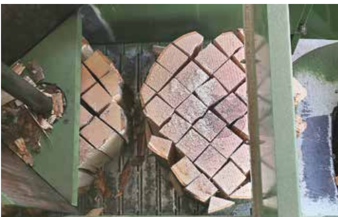
Cuneo per sistema di spacco verticale automatico
