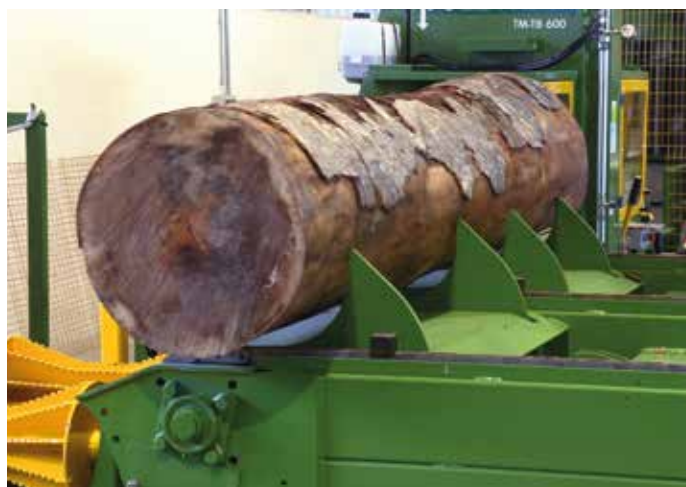
Caricatronchi a 3 catene, lunghezza 4 metri
