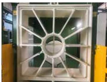
Settore di spacco amovibile per manutenzione con 10 oppure 12 oppure 16 oppure 18 oppure 24 vie
