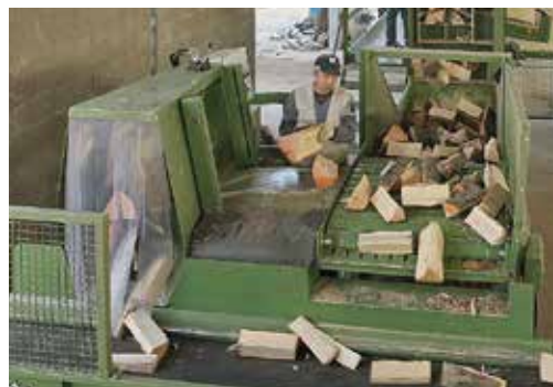
Stazione di spacco 11 Ton, griglia 2+4 vie
