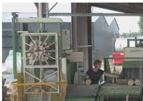
Stazione di spacco 32 Ton, griglia 2+4+6+16
