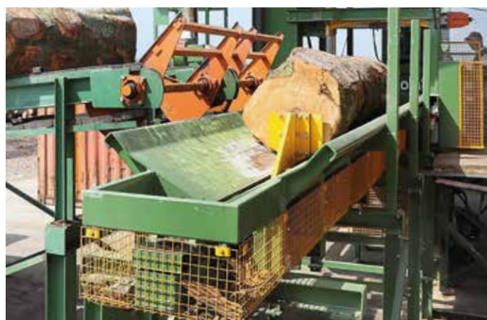
Canale di carico con spintore posteriore
