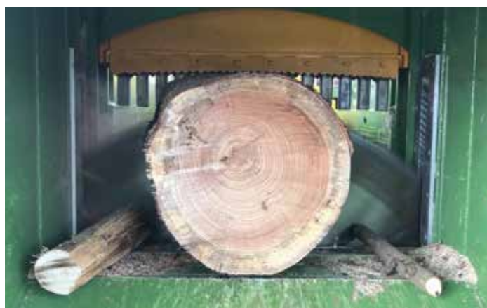
Alimentazione con tronchi di grosso diametro (TLA)
