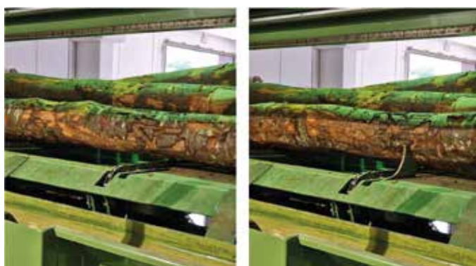
Sistema caricamento mezzaluna a scomparsa
