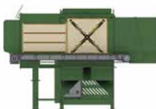
Sistemi di spacco orizzontale KX e KV per processare ceppi di qualsiasi natura.
