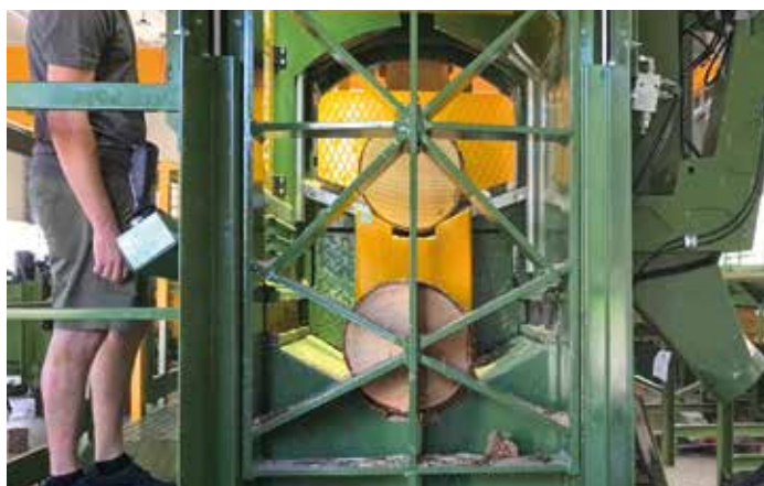
TLF - Configurazione di lavoro taglio/spacco
