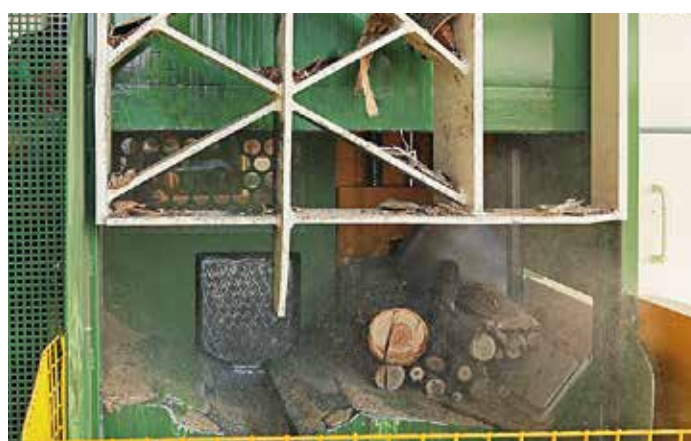
TLC - Configurazione di lavoro solo taglio
