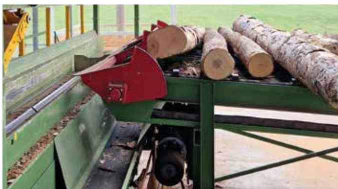
Sistema di caricamento a mezzelune
