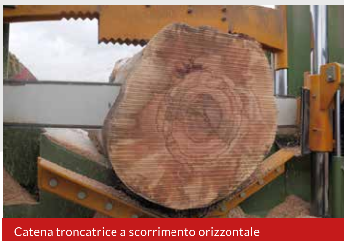
Bloccaggio legna idraulico a ghigliottina
