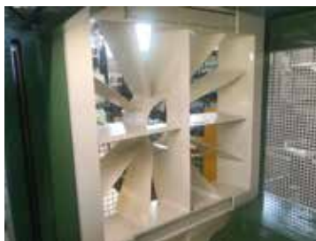
Settore di spacco amovibile per manutenzione con 10 oppure 12 oppure 16 oppure 18 oppure 24 vie
