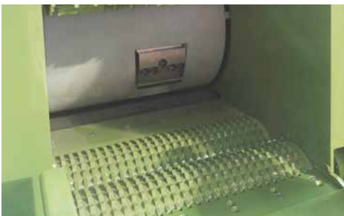
Sistema di introduzione a rulli per alimentazione automatica
