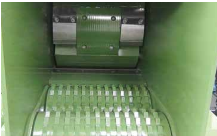
Rulli di alimentazione e tamburo a 3 coltelli
