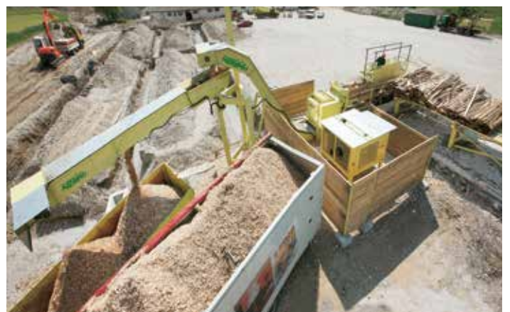
Convogliatore di scarico a palette con sistema orientabile
