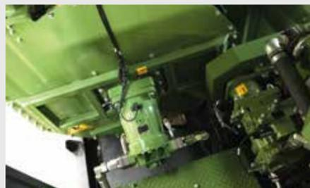
Hydraulikmotor für Auswurfgebläse
