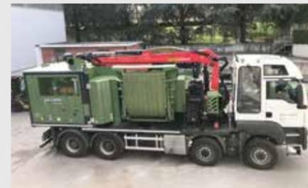
Maschine zusammengefahren - Transportposition
