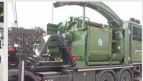
Kranantrieb durch den Maschinenmotor
