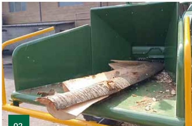
En el primer caso, la astilladora está equipada con una robusta barra de seguridad que garantiza al operador presente en la máquina un uso seguro de la misma, mientras que en la configuración de alimentación mecánica el operador dispone de un mando a distancia para gestionar las funciones principales desde una distancia.
