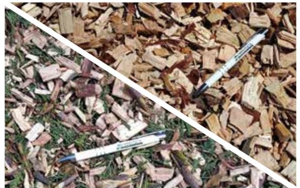
Il sistema di taglio caratterizzato dal tamburo chiuso e la griglia di calibratura intercambiabile a seconda delle esigenze, permettono di ottenere un cippato uniforme ed omogeneo anche da materiale di poco valore.
