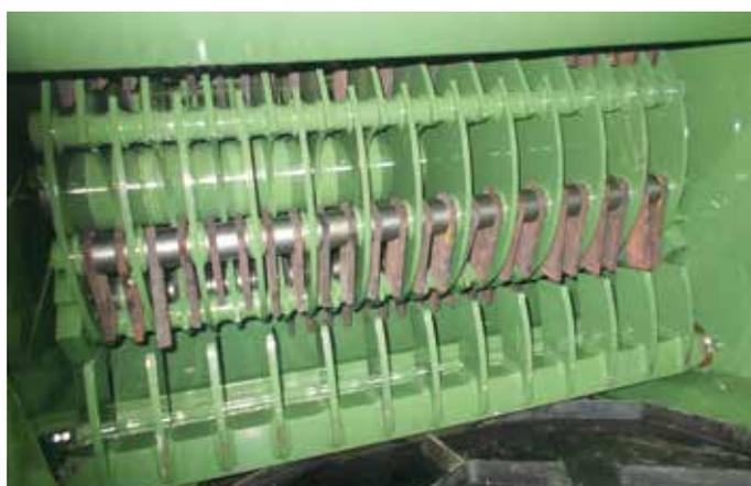
Rotor S 9000 avec des marteaux mobiles et un contre-marteau
