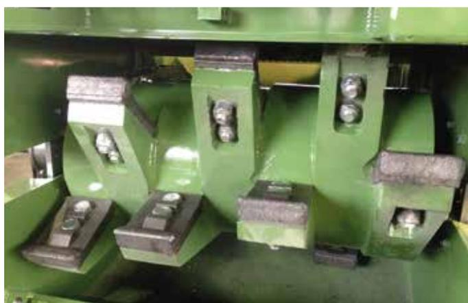
Rotor MF 10 000 avec des marteaux fixes
