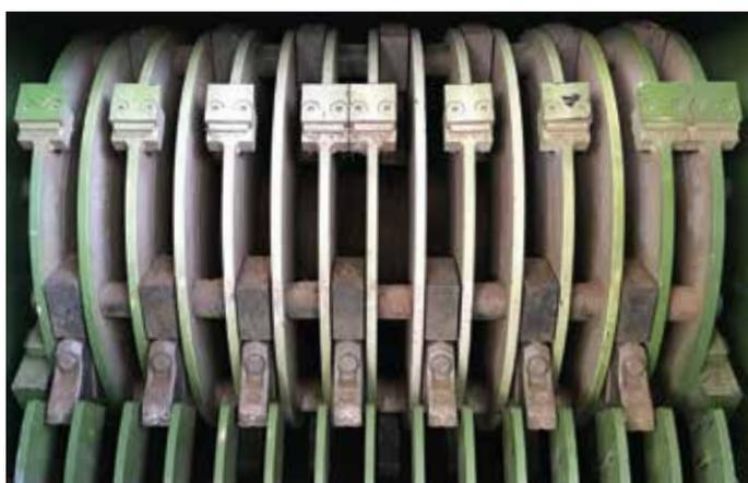
Rotor S 10 000 avec des marteaux mobiles et des contre-marteaux
